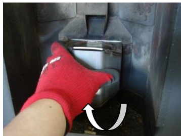
上を軸にして下側を手前に引き出す
